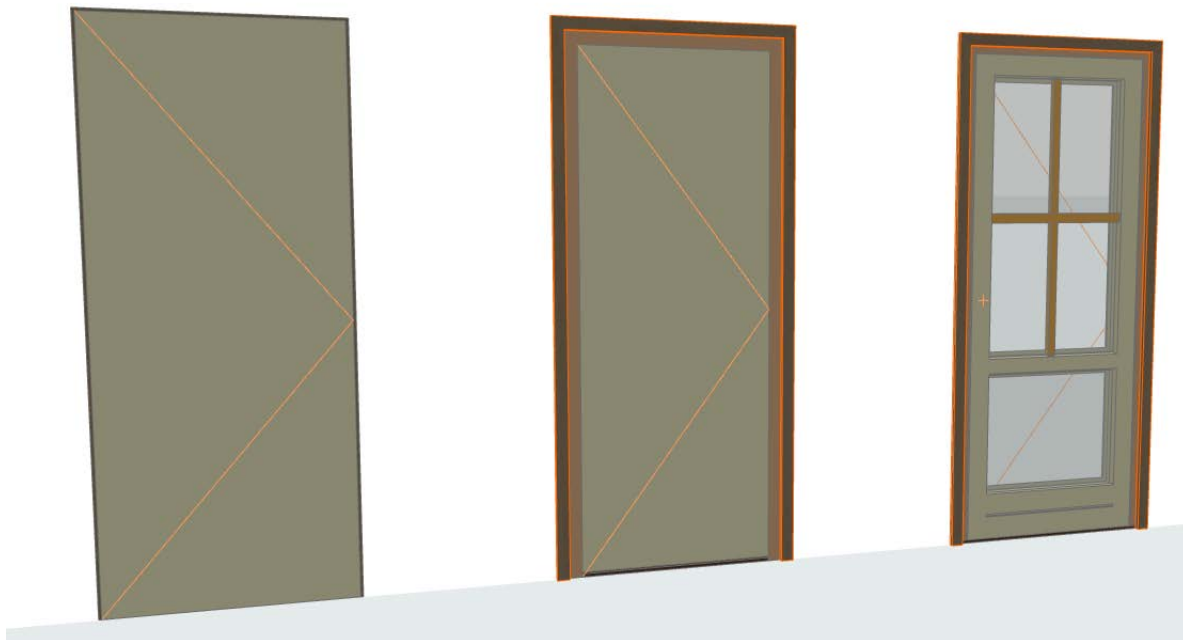
Porte : Associations de niveaux de détail schématique, simplifié et entier
