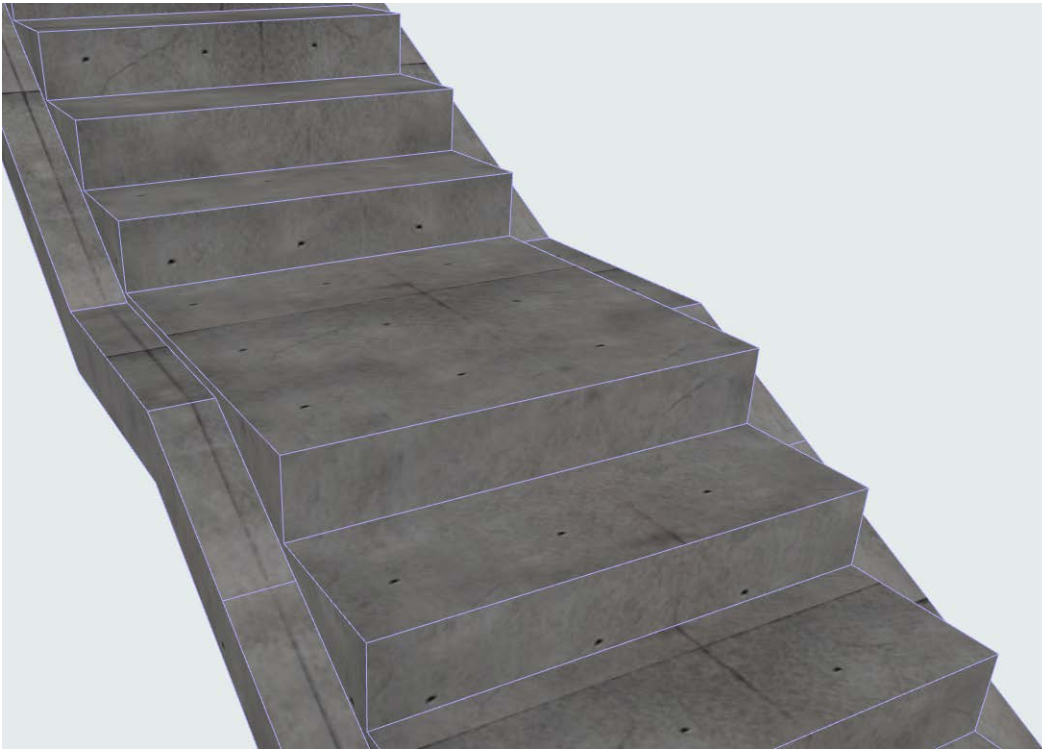
Escalier monolithique avec drainage des deux côtés
