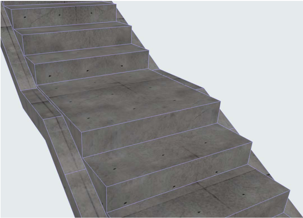
Escalier monolithique avec drainage des deux côtés
